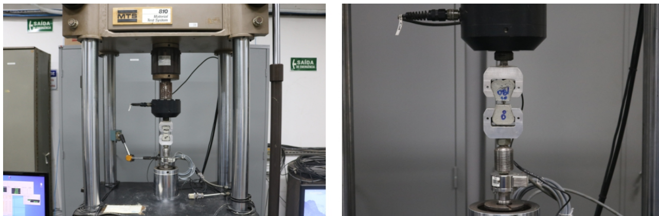
(a) (b) Figura 2 – Foto do ensaio de arrancamento da fibra
