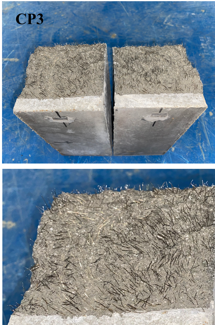
Figura 4.6 - Seção transversal após ensaio de flexão de três pontos - Amostra CP3
