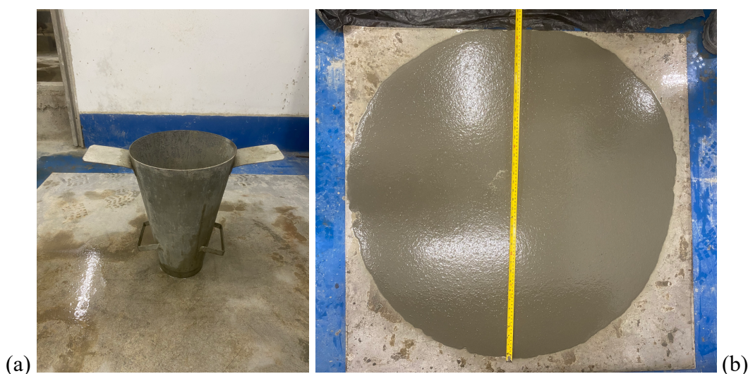
Figura 4.1 - Ensaio de espalhamento (a) montagem (b) resultado
