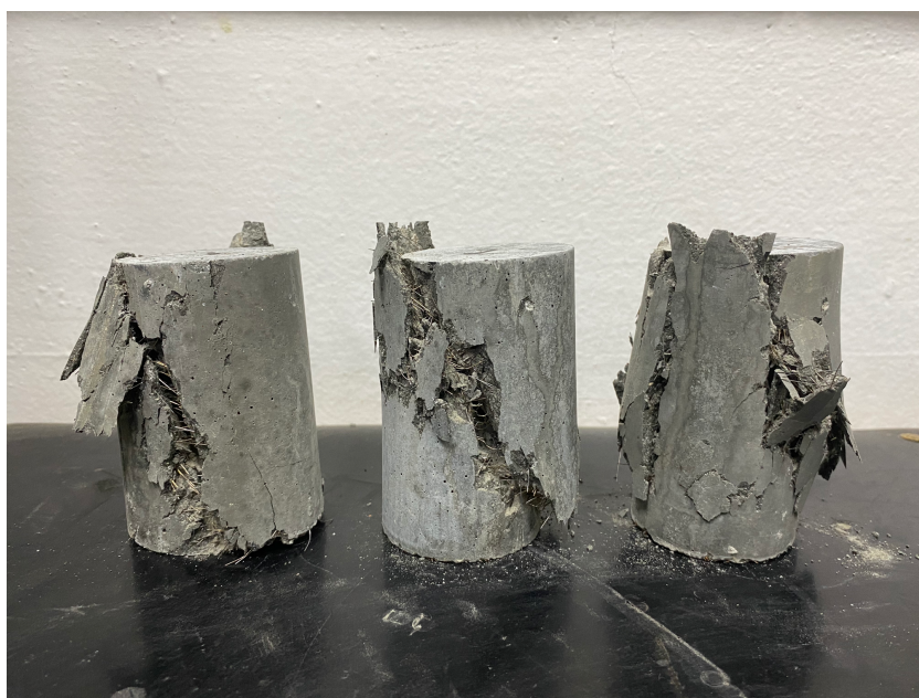
Figura 4.3 - Corpos de prova após a ruptura sob compressão axial
